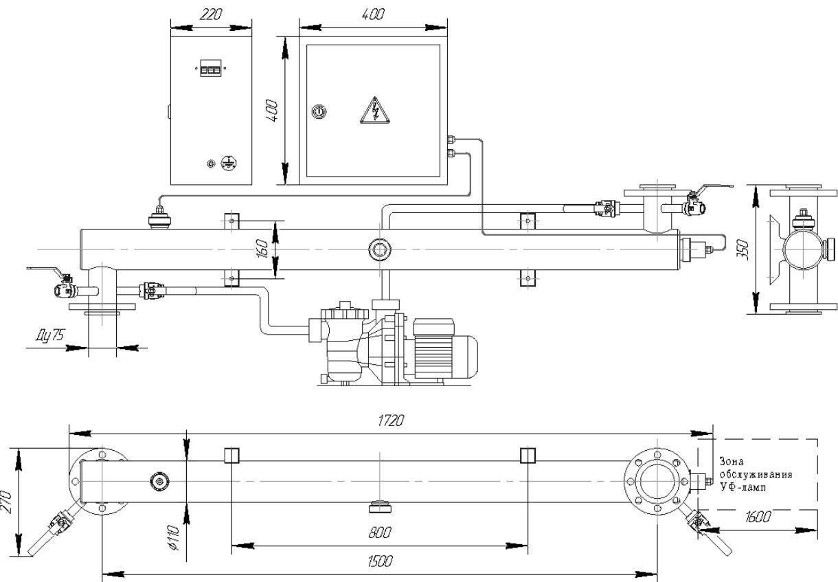
1. Диаметр присоединительного патрубка определяется проектом заказчика. Базовое значение Ду75.
