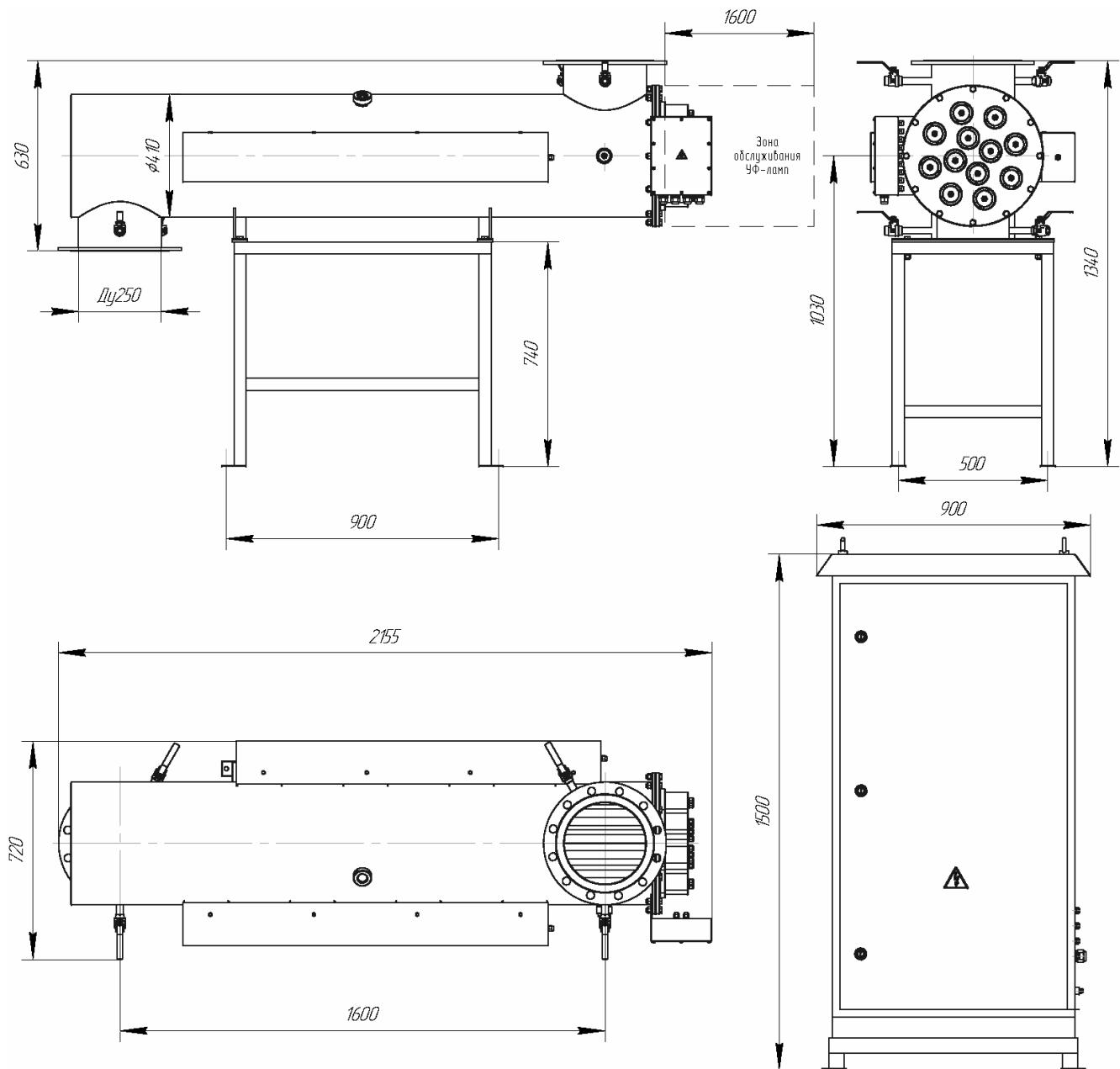
1. Диаметр присоединительного патрубка определяется проектом заказчика. Базовое значение Ду250.
