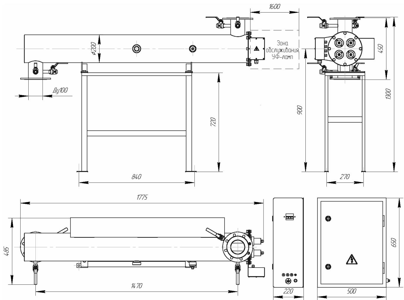
1. Диаметр присоединительного патрубка определяется проектом заказчика. Базовое значение Ду100.
